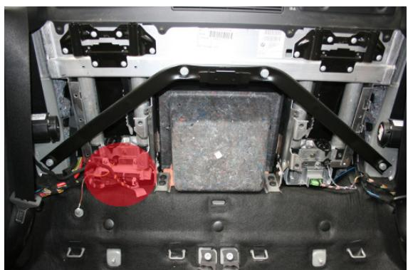
Von diesem muss der große schwarze Stecker entfernt werden. Hierzu den Rasthaken eindrücken, den Sicherungsbügel umlegen und den Stecker entfernen.
