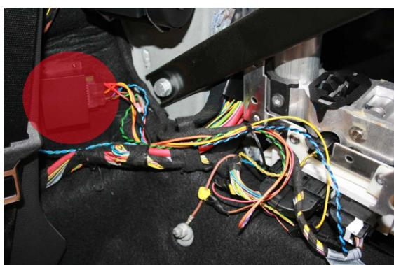
Befestigen Sie das gelieferte Modul mit dem beiliegendem Klettklebeband in Fahrtrichtung auf der rechten Seite an der Seitendämmung.
