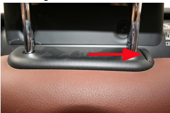
Dazu die Verriegelung rechts an der Halterung eindrücken und dabei die Kopfstütze nach oben ziehen.
