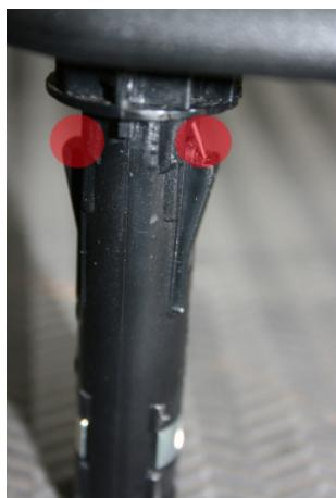
Dies geschieht zunächst an einer Seite und im Anschluss an der Zweitens. Wenn beide Seiten gelöst wurden, kann der gesamte Halter nach oben herausgezogen werden. Dies geht unter Umständen ein wenig streng.
